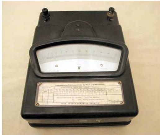
Der Voltmeter von Trüb, Täuber & Co. Die Voltstärke wird durch einen Lichtstrahl, statt mit einem Zeiger angezeigt. (Fundus Pro Hombrechtikon)
