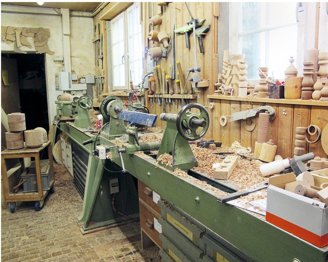
Der Tatort: In der hinteren Drehbank ist verleimtes Birnbaummassivholz eingespannt, das zu hölzernen Urnen verarbeitet wird.
